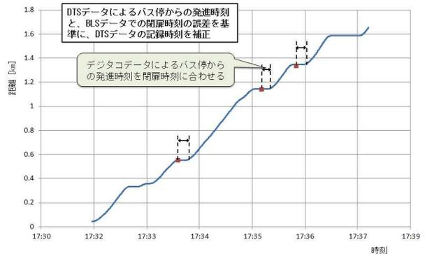
図3 時刻補正後のDTS データ走行軌跡
